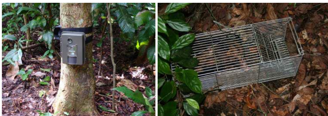
Detalhe da armadilha fotográfica utilizada e Armadilha Tomahawk utilizada na captura de pequenos mamíferos.
