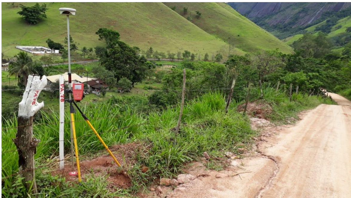
Foto: Rastreamento da poligonal de apoio.
