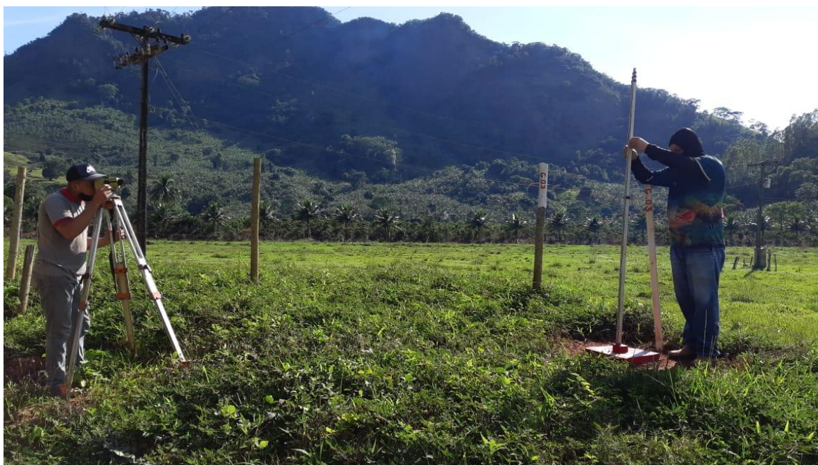
Foto: Nivelamento Geométrico.
