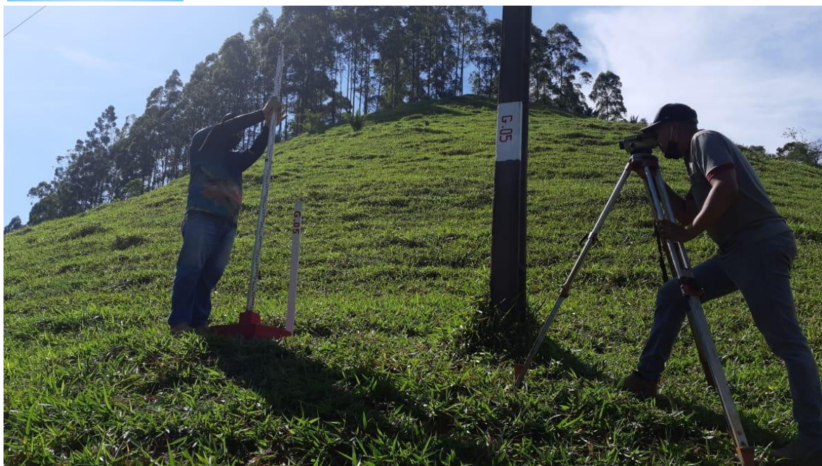
Foto: Nivelamento Geométrico.
