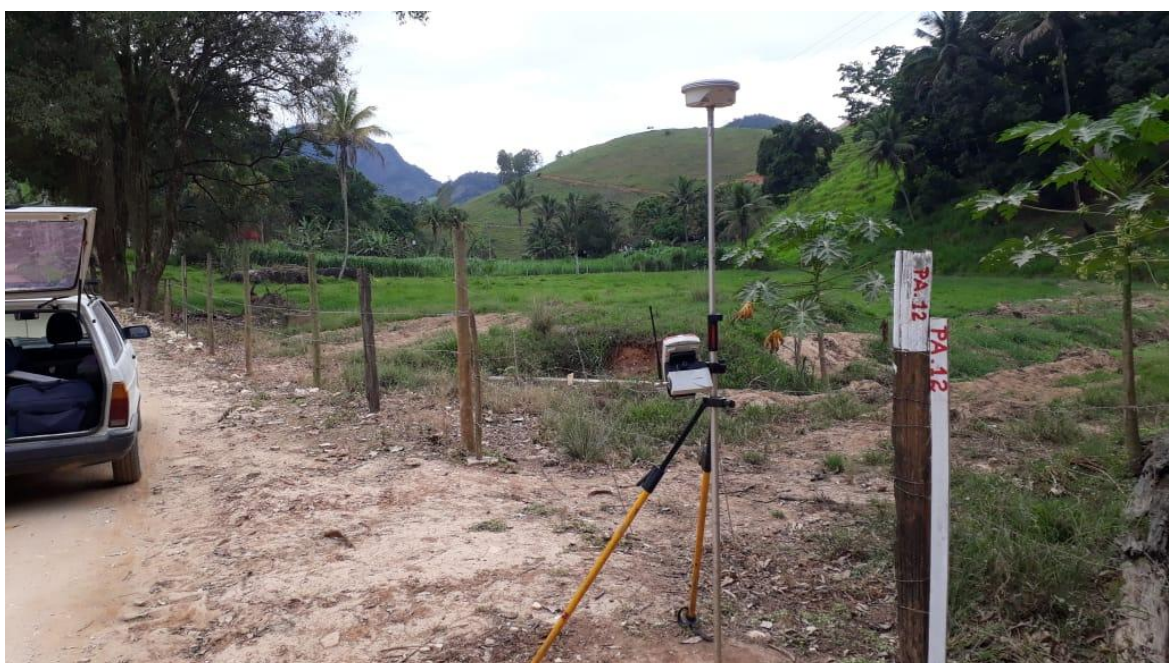
Foto: Rastreamento da poligonal de apoio.
